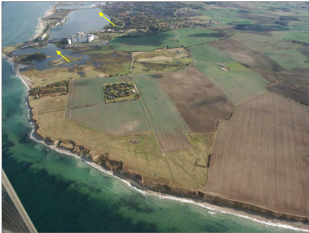
Abb. 2: Abbrüche an Steilufers (Vordergrund) und Bildung der Nehring (Hintergrund) Regulierung der Wasserdynamik durch technische Bauwerke (Pfeile)
