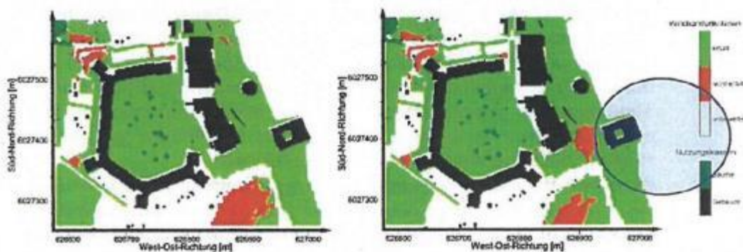
Abb. 11: Einhaltung der Windkomfortkriterien im Ist-Zustand (links) und Plan-Zustand (rechts).
