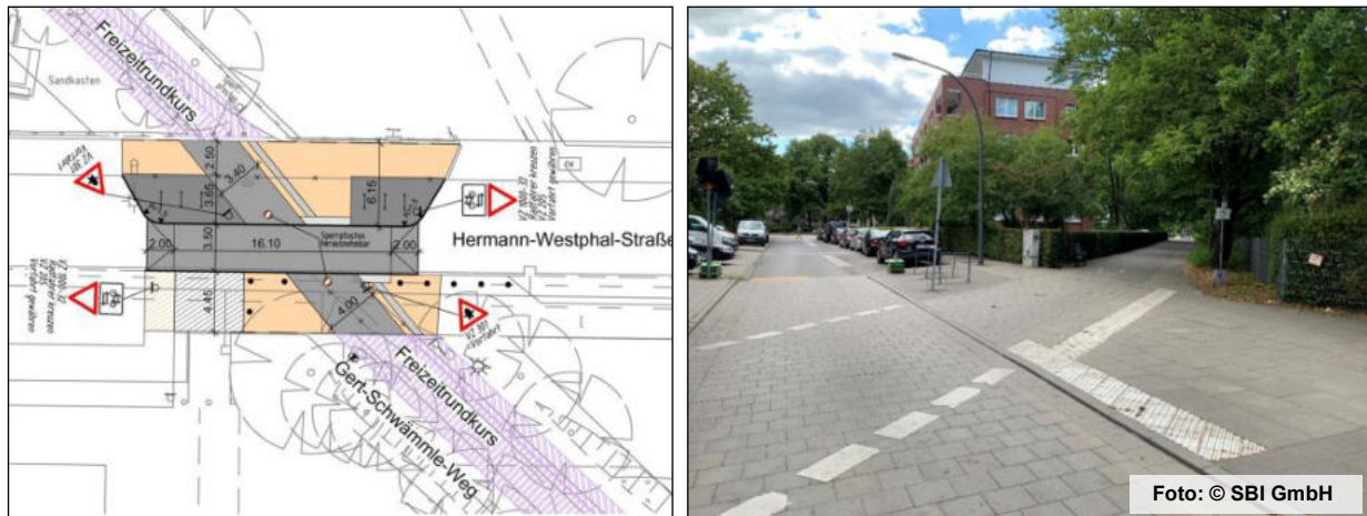
Abbildung 83: Bevorrechtigte Querung einer Radverkehrsroute im Nebenstraßennetz links: Lageplankonzept [27]; rechts: nach Umsetzung der Planung (eigene Aufnahme)
