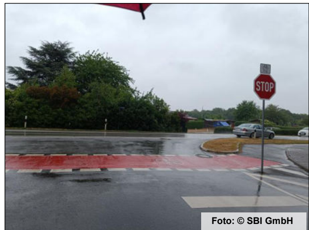
Abbildung 33: Roteinfärbung und Beschilderung von Furten mit Radverkehr in Gegenrichtung (ohne Benutzungspflicht – eigene Aufnahmen)
