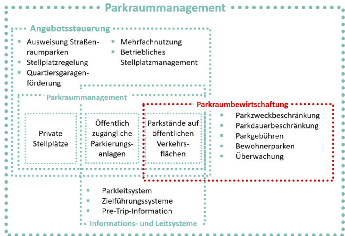
Abbildung 95: System des Parkraummanagements [35]
