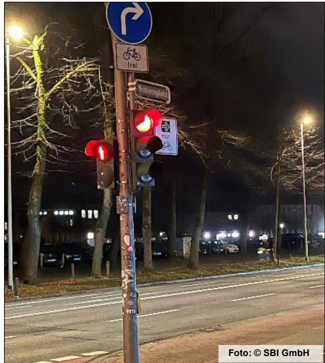
Abbildung 86: Konzeptskizze und Beispielbild freies Rechtsabbiegen für den Radverkehr mit Grünpfeil (links: [17]; rechts: eigene Aufnahme)
