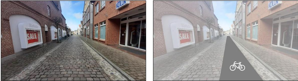
Bild 5-13: Wechsel der Fahrbahnbefestigung am Beispiel der Werftstraße
