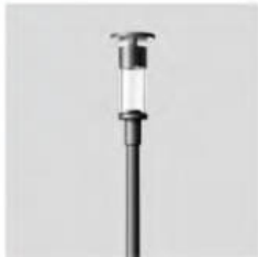
Aufsatzleuchten aus Aluminium und Edelstahl (pulverbeschichtet in DB 703 anthrazit) mit einem klaren Kunststoffzylinder mit einem Reflektor aus eloxiertem Reinstaluminium. Die Lichtstärkeverteilung ist asymmetrisch-bandförmig. Es kann die Mastleuchte 77164K3 der Firma BEGA verwendet werden.
