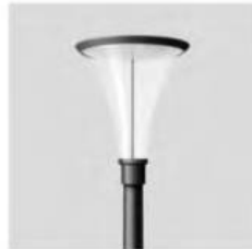
Aufsatzleuchten aus Aluminium und Edelstahl (pulverbeschichtet in DB 703 anthrazit) mit einer klaren zylindrisch unten zulaufernden Kunststoffabdeckung mit einem Reflektor aus eloxiertem Reinstaluminium. Die Lichtstärkeverteilung ist asymmetrisch-bandförmig. Es kann die Mastleuchte 84252K3 der Firma BEGA verwendet werden.
