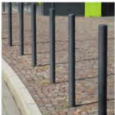
Ø 60 mm Pfosten des Typs Record der Firma Union Freiraum. Die feuerverzinkten Stahlpoller erhalten eine pulverbeschichtete Oberfläche in DB 703 anthrazit. Ortsfest zum Betonieren oder Aufschrauben.
